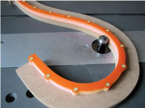
Este nuevo producto CMT se sujeta con tornillos en cualquier tablero de madera, MDF y aglomerado para crear formas de manera rápida y segura. Usted puede utilizar tornillos tradicionales de cabeza avellanada, que están ampliamente disponibles en el mercado.
